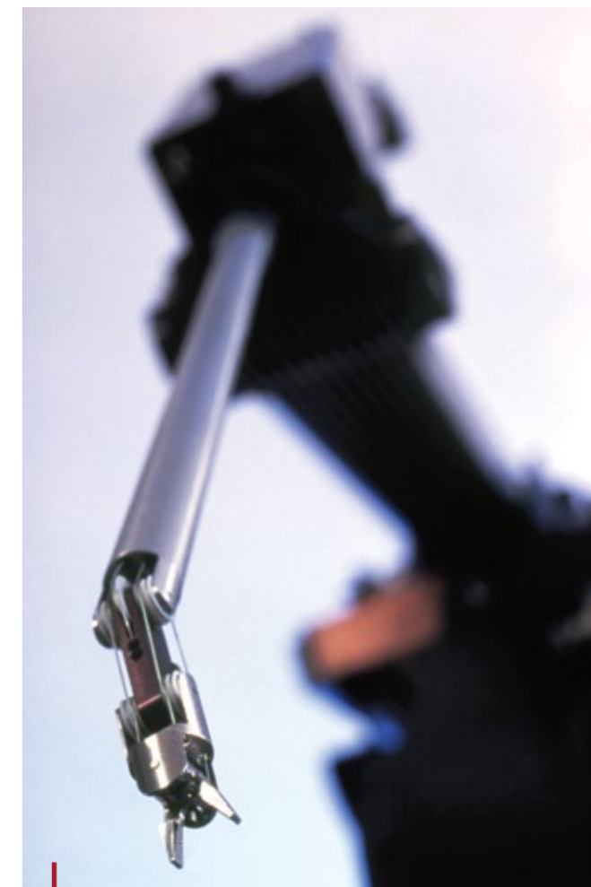
Robot zwany Black Falcon do zabiegów laparoskopowych i endoskopowych, wykorzystywany także w kardiochirurgii.
